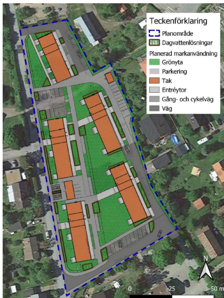
Bild 10 Bilden redovisar förslag på placering och yt-dimensionering av dagvattenlösningar i form av regnbäddar. Illustration av Geosigma.
