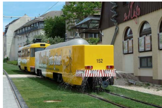
Figur 90. Bevattnings av gröna spår med regnvatten i staden Gera. Bildkälla: GVB Verkehrs- und Betriebsgesellschaft Gera mbH)
