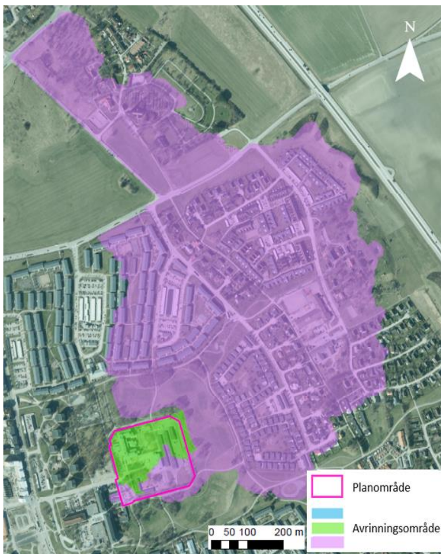
Figur 9. Planområdets ytliga avrinningsområden, från SCALGO Live. De olika färgerna motsvarar olika rinnriktningar inom planområdet. © Lantmäteriet.
