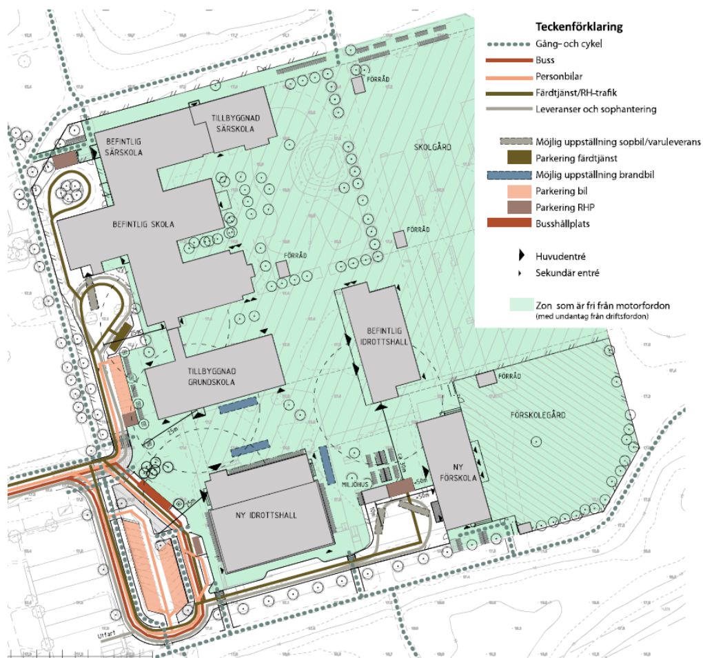
Figur 26 Illustrationen visar föreslagen angöring för olika trafikslag inom planområdet. Detta är ett förslag på hur byggnader och angöringsytor kan lösas. Illustration av Ramboll.
