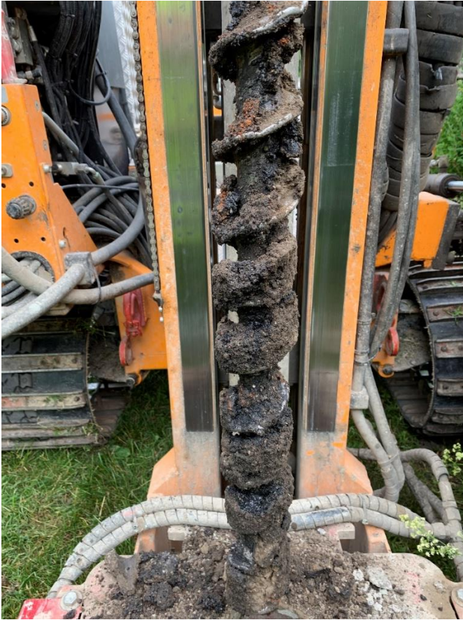
Figur 6 Skrubborrprovtagning i borrhypunkt BG19010, 1,0 – 2,0 m.
