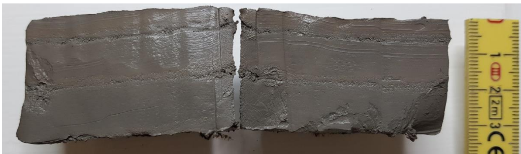
Figur 3 Borrpunkten, BG19008, 8,0 m, Jordprovet i övre delen av mellanhylsan delad longitudinellt provhylsan med id Bjerking 012.
