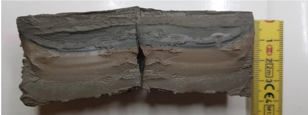
Figur 1 Borrpunkten, BG19008, 3,0 m, Jordprovet i övre delen av mellanhylsan delad longitudinellt provhylsan med id Bjerking 450.
