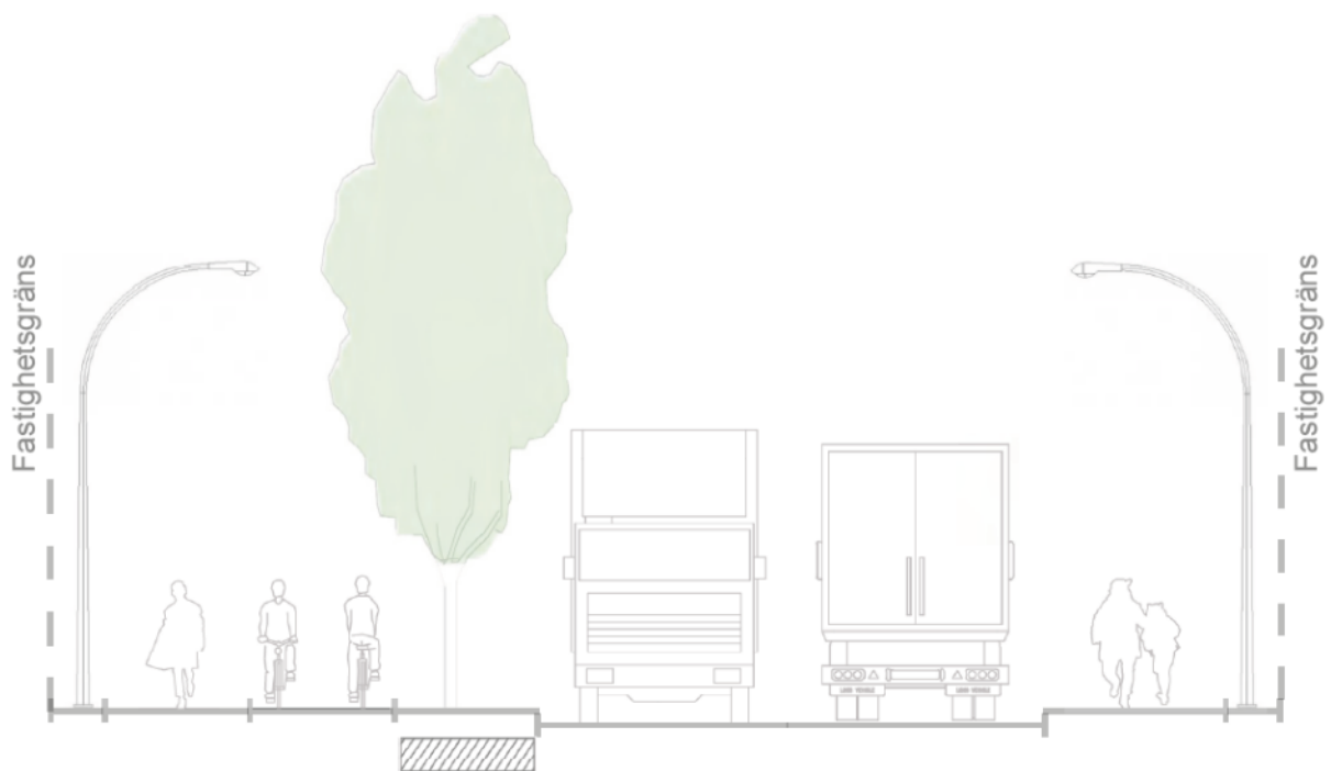
Exempel på gatusektion för en lokalgata inom planområdet. I planområdet säkerställs gatusektionen till 17 meter inom allmän plats för lokalgator. Sektionen möjliggör gång på bägge sidor om gatan samt cykelbana på ena sidan.
