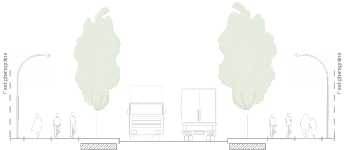
Exempel på gatusektion för huvudgatan inom planområdet. I planområdet säkerställs gatusektionen till 24 meter inom allmän plats för huvudgatorna. Sektionen möjliggör gång- och cykeltrafik på bägge sidor om gatan.
