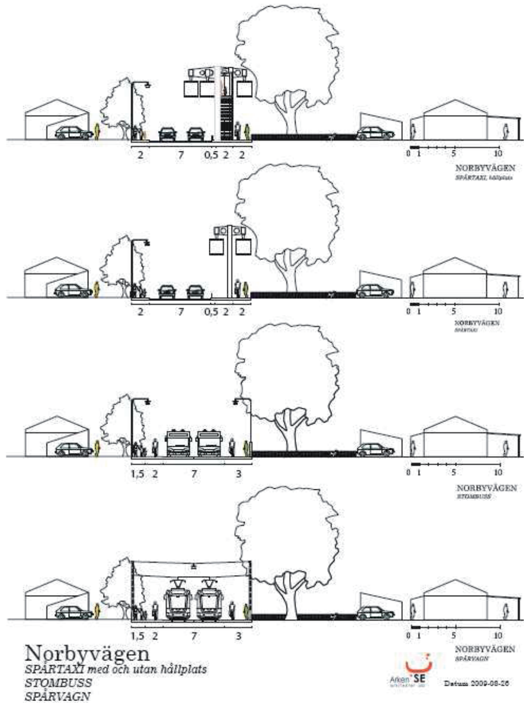
Figur 6.12 Sektioner med spårtaxi (med och utan hållplats), stombuss och spårvagn för Norbyvägen
