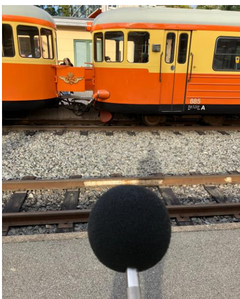
Figur 4. Ljudet från rälsbussarna kommer främst från den bakre delen av den främre vagnen.
