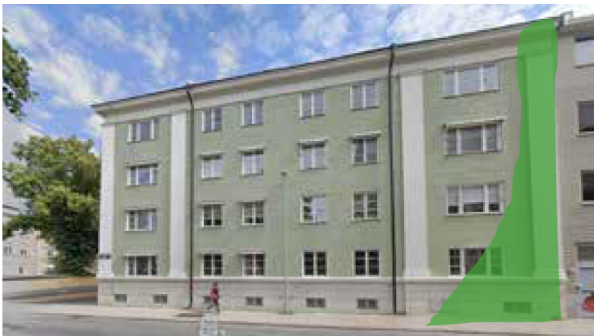
Bild av fasaden på brf Sleipner mot Dragarbrunnsgatan som visar den del av fasaden som beräknas få mindre än 20% dagsljus efter ett genomförande av detaljplanen.
