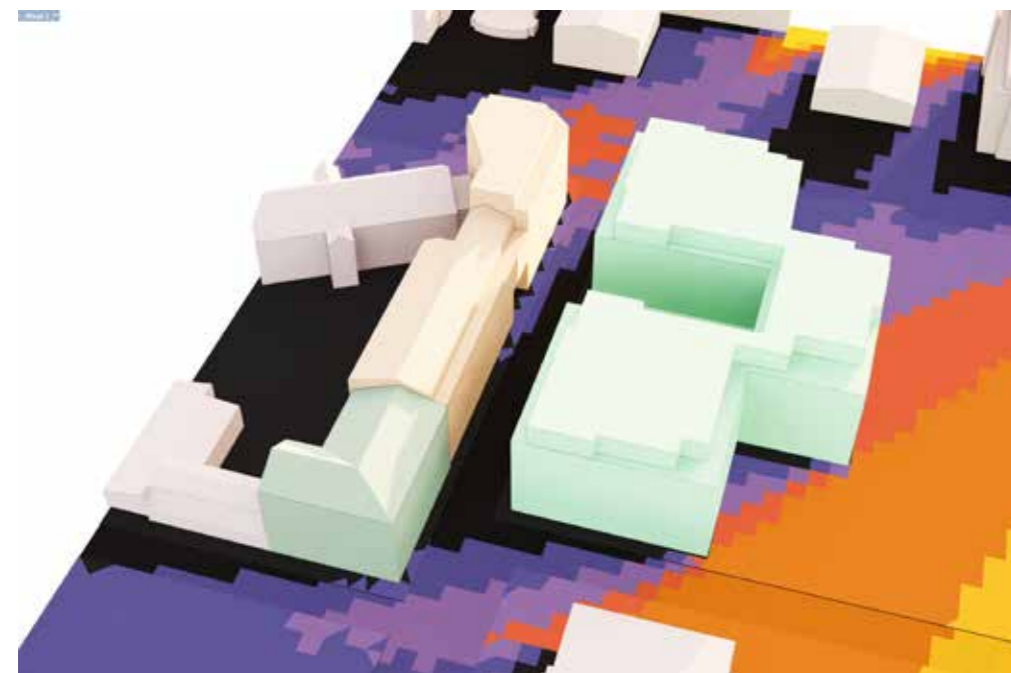
Före ombyggnad. Antal timmar med direkt solljus på gatan.
