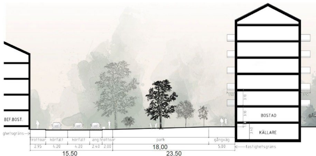
Bild 37 Gatusektion över Hamnesplanaden, sett västerifrån, Alma arkitekter. De individuella måtten inom gatusektionen kan komma att ändras vid utbyggnad.
