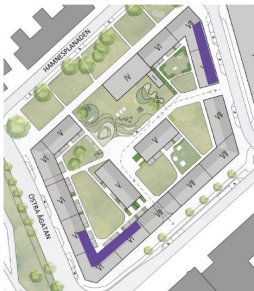
Fasader som inte får något direkt solljus enligt solljusstudien. Underlag från Alma arkitekter, bearbetat av Uppsala kommun.
