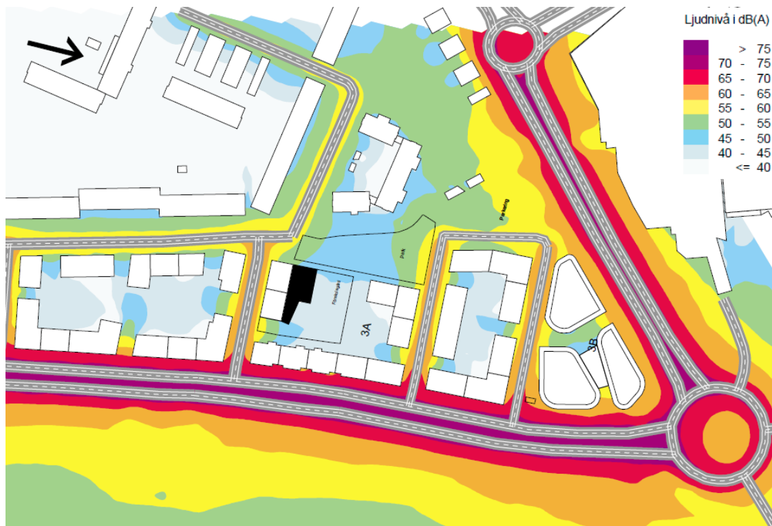
Bilden visar en ljudutbredningskarta för dygnsekvivalent nivå, 1,5 meter över mark. Svart markerad byggnad är förskolan. Observera att byggnaderna närmst rondellen inte ingår i denna detaljplan, utan ska prövas i detaljplan för östra Sala backe etapp 3b, Sweco.
