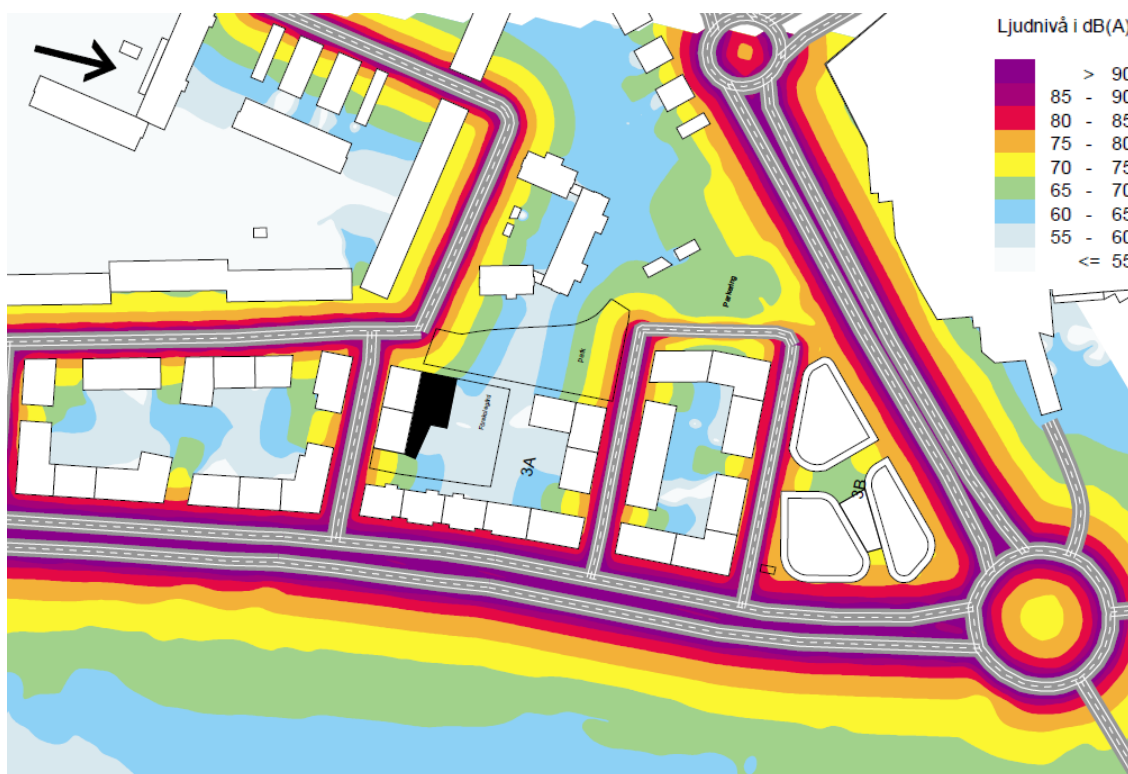
Bilden visar en ljudutbredningskarta för maximala nivåer, 1,5 meter över mark. Observera att byggnaderna närmst rondellen inte ingår i denna detaljplan, utan ska prövas i detaljplan för östra Sala backe etapp 3b, Sweco.
