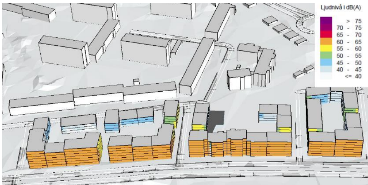
Bilden visar ekvivalenta ljudnivåer vid fasader mot Fyrislundsgatan. Sweco
