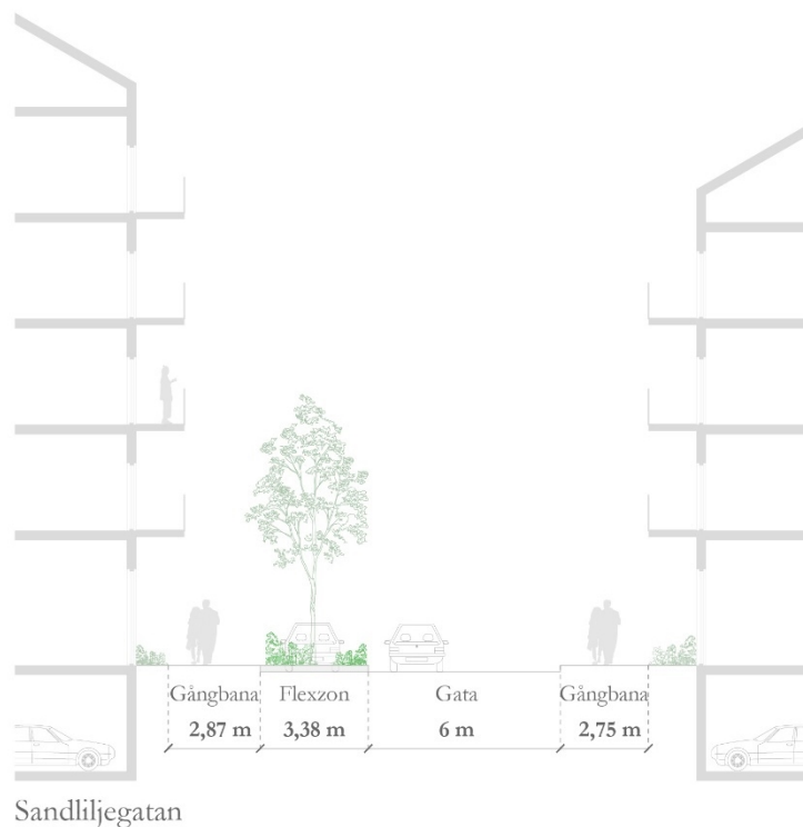
Bilden visar en principsektion för Sandliljegatan. Sektionen ser lika dan ut för Ängsnyckelgatan.
