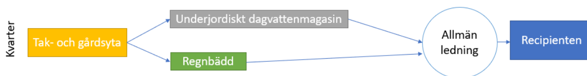
Figur 6-1. Konceptuell modell över hur dagvattnet från planområdet fördröjs, renas och avleds till recipienten.
