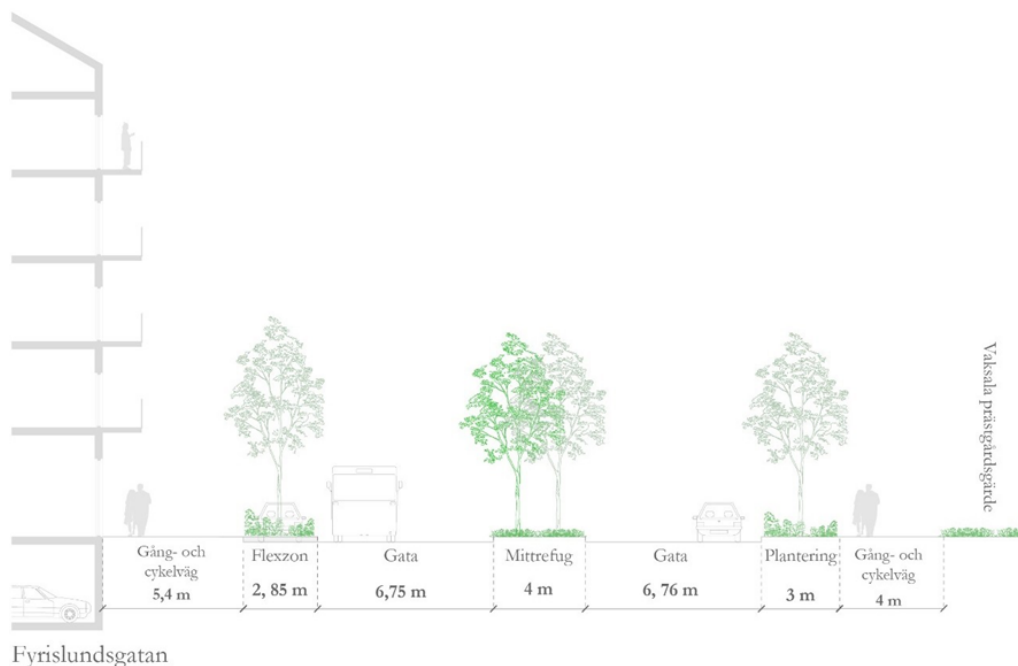
Figur 21, Principsektion för Fyrislundsgatan.
