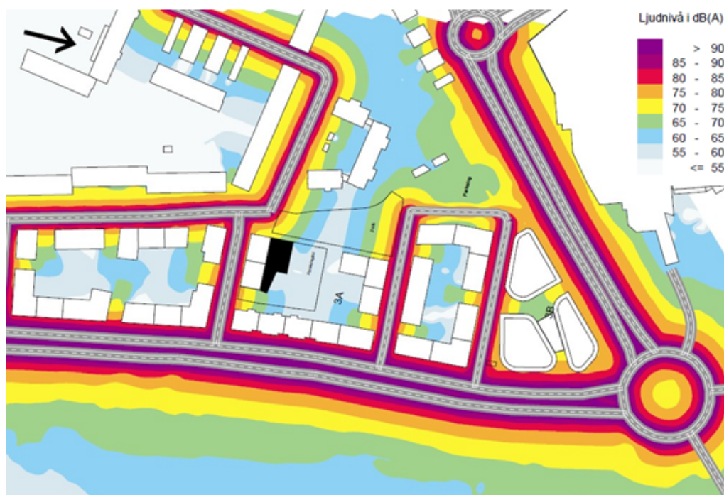
Figur 31. Bilden visar en ljudutbredningskarta för maximala nivåer, 1,5 meter över mark. Observera att byggnaderna närmast rondellen inte ingår i denna detaljplan, utan ska prövas i detaljplan för östra Sala backe etapp 3b, Sweco.
