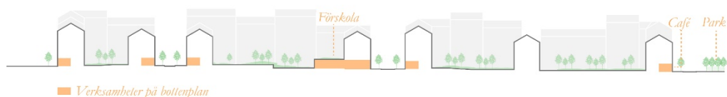
Figur 16, Sektion som visar principer gällande verksamheter på bottenplan. Lokalerna kan ligga i den del av bottenvåningen som vetter mot gatan. Mot gården kan det vara bostäder.
