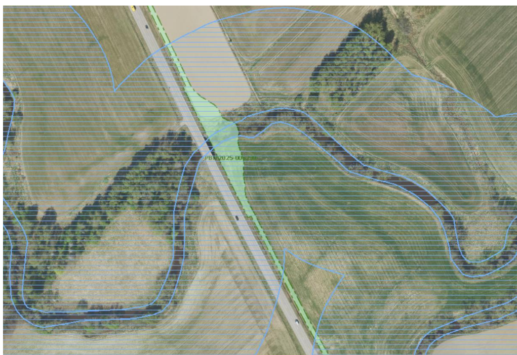
Figur 22 Del av planområdet (grönmarkerat) som går inom strandskyddat område. Marken består till största del av jordbruksmark i anslutning till väg 272 och dess vägdike. Delen inom strandskyddat område är cirka 3 000 kvadratmeter.
