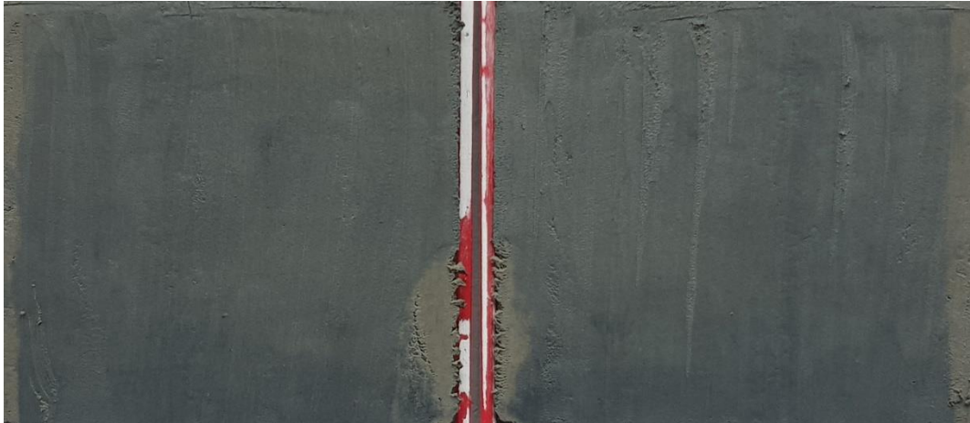
Figur 1 Borrpunkten, 22W01, 3,0 m, Jordprovet i nedre delen av mellanhylsan delad longitudinellt provhylsan med id Bjerking 1001.
