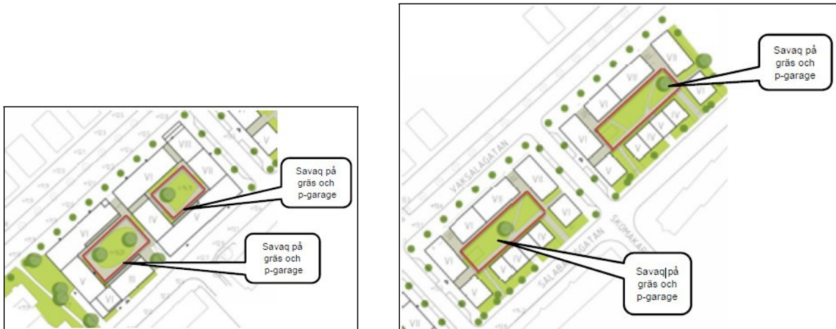
Förslag på fördröjning av dagvatten på gårdarna med hjälp av magasin. (Bjerking)
