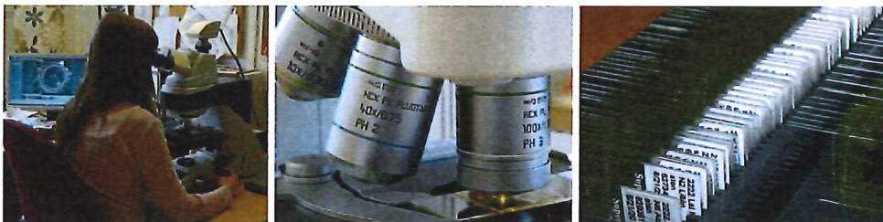
Figur 1. Kiselalgsanalys görs i ljusmikroskop i 1000 gångers förstoring med oljeimmersionsobjektiv. Mikroskopet ska helst vara utrustat med interferenskontrast, vilket gör att man kan se mycket små former tydligare än med andra tekniker.
