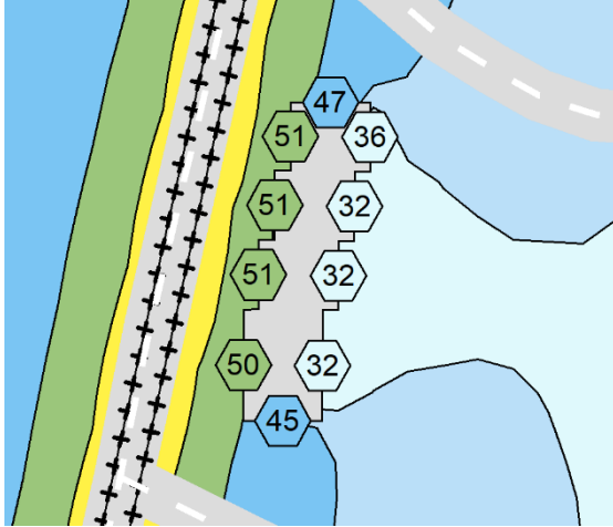
Figur 4 Exempel på redovisning av fasadbullernivå. De angivna nivåerna är så kallade frifältsvärden, vilket betyder ljudnivå utan ljudreflex i den egna fasaden.
