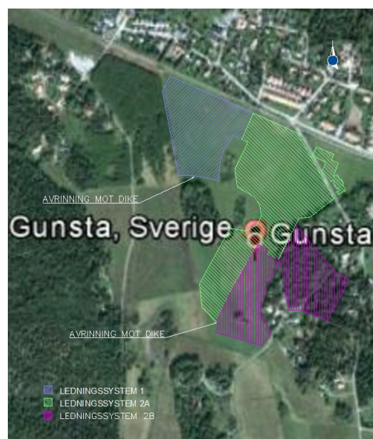
Figur 6. Schematisk översikt av avrinningsområden för ledningssystem och dagvattendammar(Eniro, 2013)
