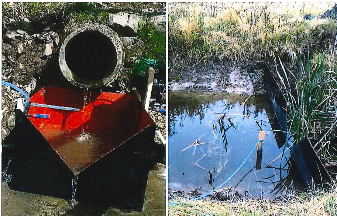
Figur 22. Exempel på V-formade mätöverfall, så kallade Thomsonöverfall, där vattnet strömmar över en specificerad vinkel. Till vänster ses mätplats vid utlopp 4 och till höger utlopp 9.
