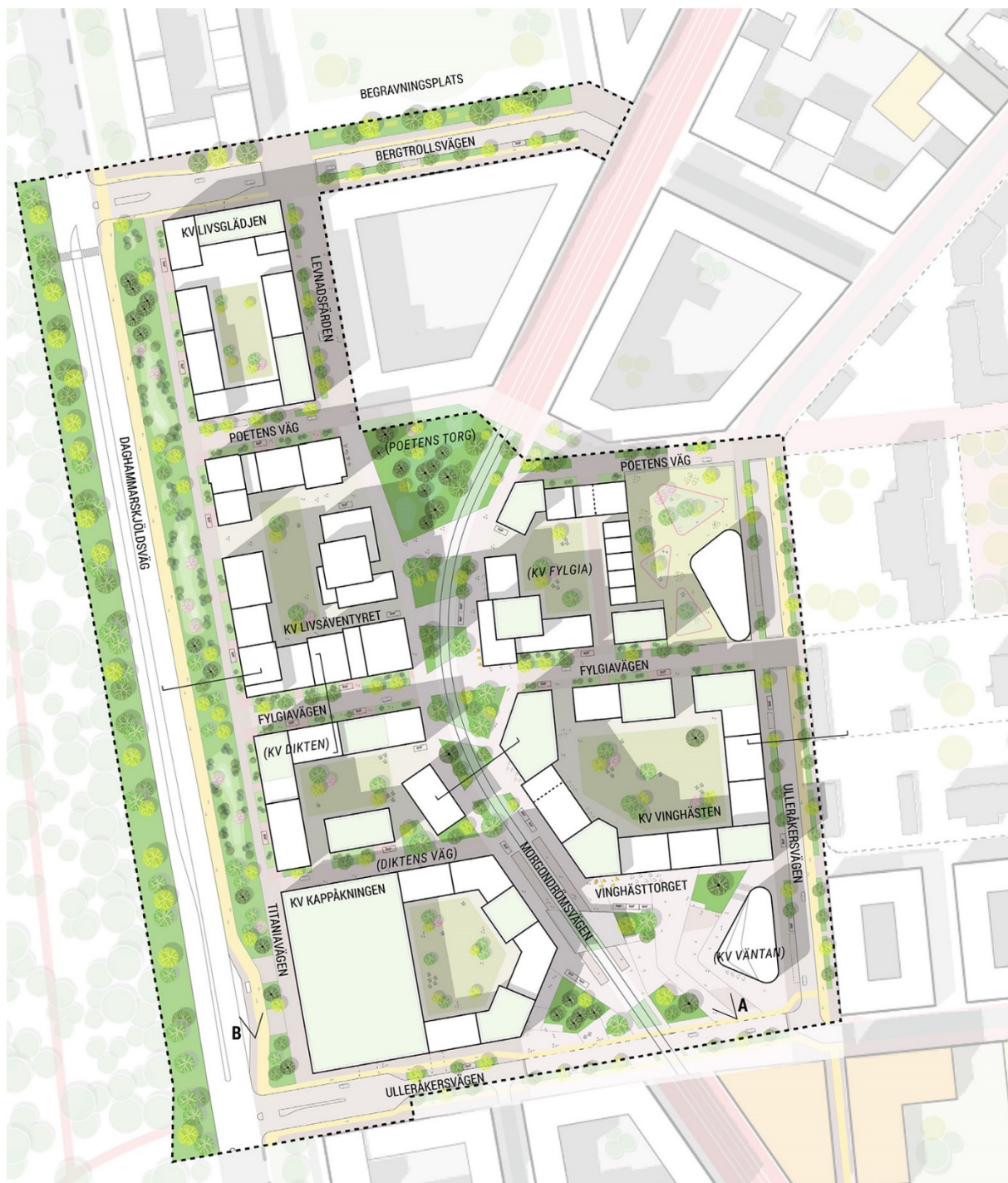
Illustrationsplan som visar en möjlig bebyggelse inom planområdet enligt planförslaget. Nya byggnader är vita/gröna. Den bebyggelse som ingår i planprogrammets stadsbyggnadsstruktur är i svagare färgton, och befintliga byggnader i anslutning till planområdet är grå. Markeringar i bilden visar var vyer och sektioner som återfinns i planhandlingen är tagna. Kvarternamn och gatunamn inom parentes är förslag, och ännu inte fastställda. Illustration: Mandaworks/Warm in the winter.
