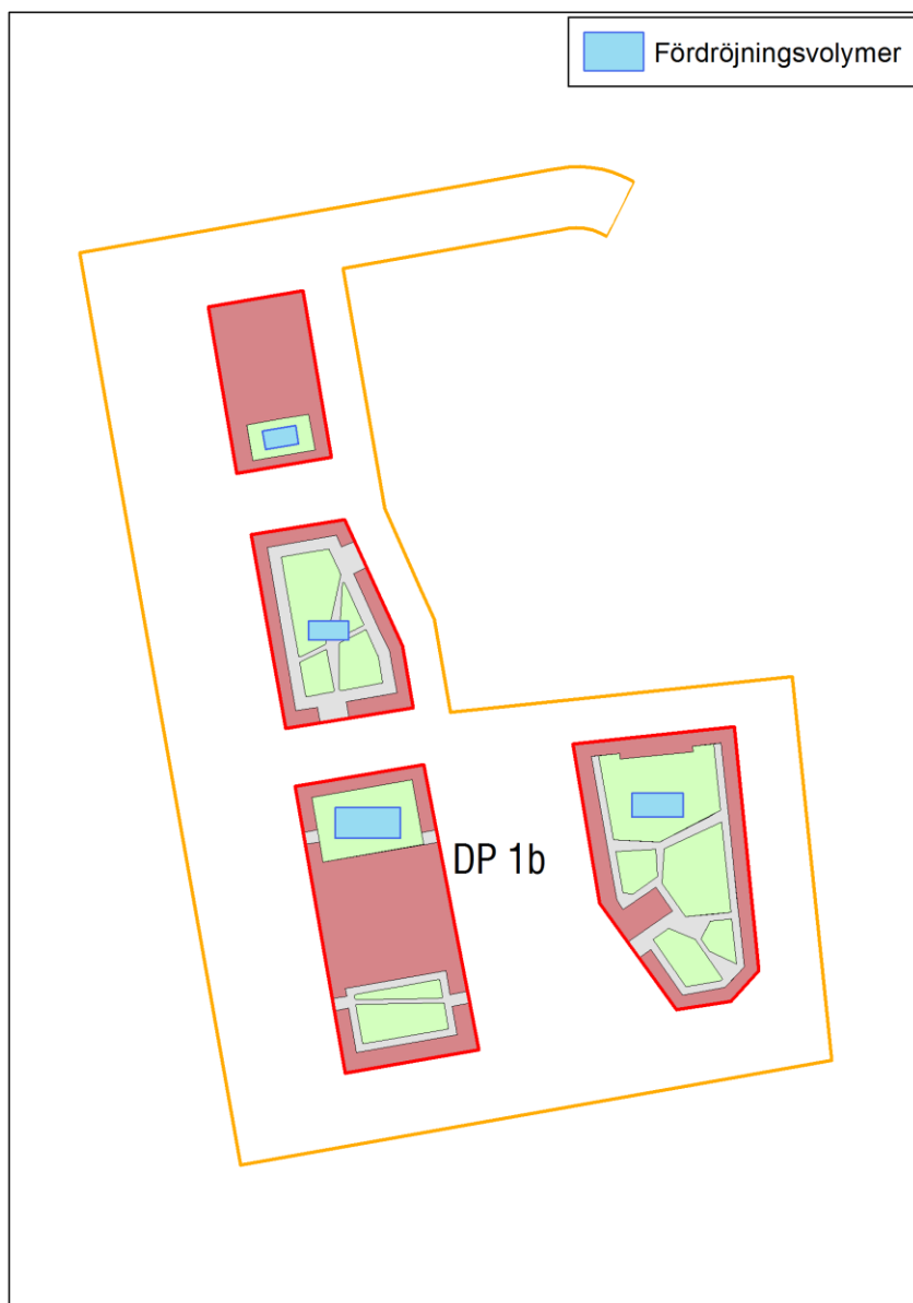
Figur 9. Bild som visar ungefärlig yta som krävs vid fördröjning vid ett 2-årsregn, förutsatt att åtgärden är 0,5 meter djup och har 30% hålrum tillgängligt för dagvatten.
