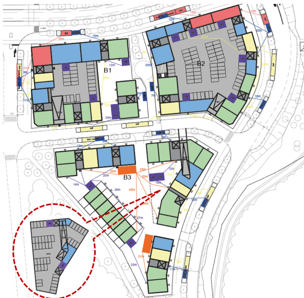
Figur 20. Illustration som redovisar en möjlig lösning av parkeringsplatser, med garage i bottenvåningarna i de norra kvarteren och garage under den nordöstra delen av det södra kvarteret. Ljusgul färg anger miljörum, blå färg redovisar plats för cykelrum. Grön färg symboliserar bostäder och röd färg lokaler. Illustration Mandaworks och Warm in the Winter, modifierad av Uppsala kommun
