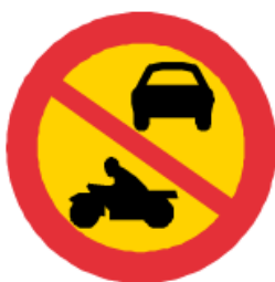
Figur 4.1-4. Vägmärke C3, Förbud mot trafik med annat motordrivet fordon än moped klass II
