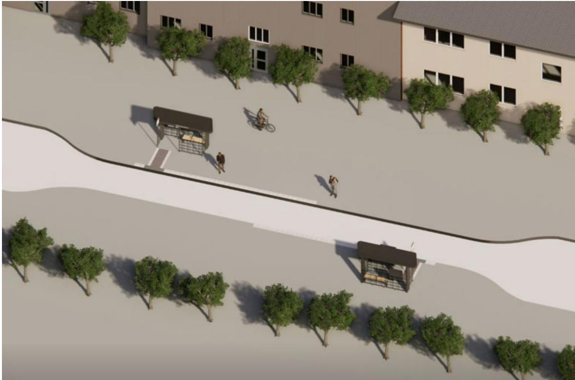
Figur 4.1.2-1. Dubbel stopphållplats (Timglashållplats). Källa Skånetrafiken
