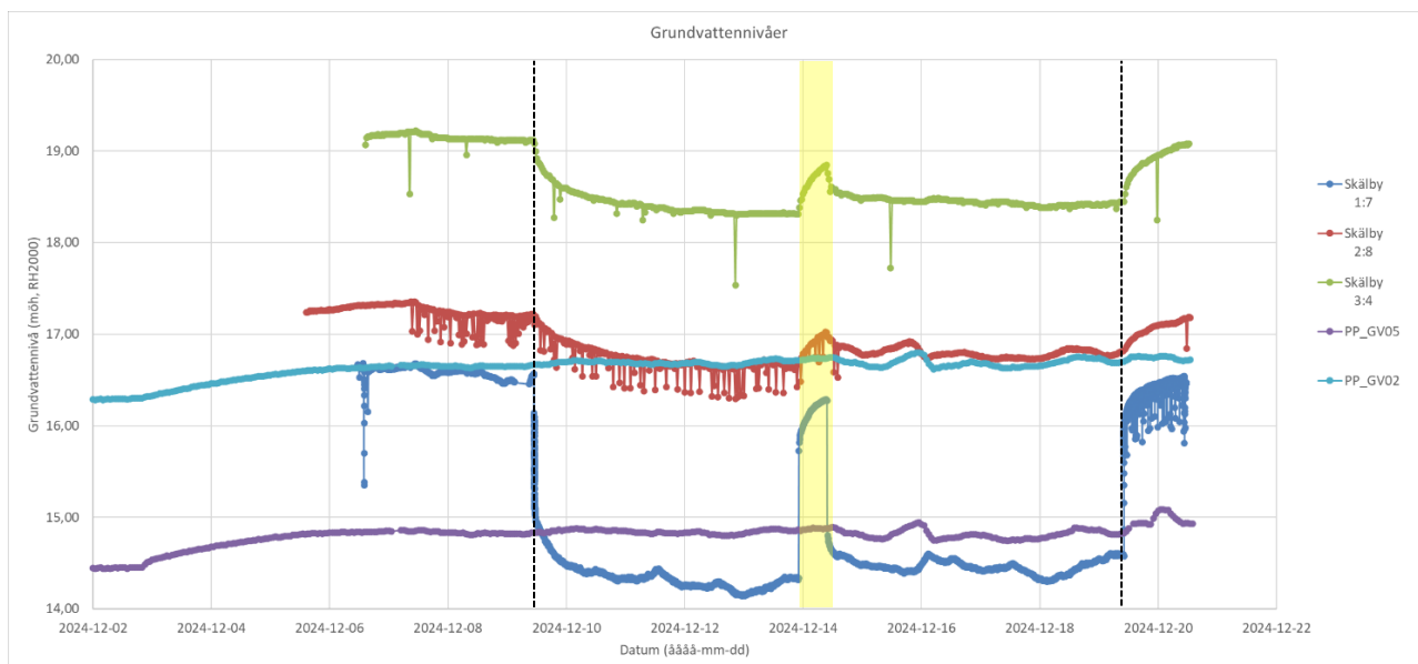
Figur 4-2. En plot med grundvattennivåer i pumpbrunnen-Vaksala Skälby 1:7, privata brunnarna Vaksala Skälby 3:4 och 2:8, Uppsala Skäve 1:5 & 1:6 samt i grundvattenrören PP_GV05 och PP_GV02. nivån i pumpbrunnen (uttryckt i meter under röröverkant). Start och slut för provpumpningen visas som lodräta streckade linjer. I svagt gult visas perioden med det tillfälliga avbrottet i provpumpningen 13-14 december. Observera att nivådata i privata brunnarna Skälby 2:8 och 3:4 påverkas av egna uttag för vattenförsörjning, inte kopplade till provpumpningen. Grundvattennivådata i grundvattenrören kan ha lite fel referensmätning för röröverkant. Inmätningen kommer från Sigmas rapport (2021).
