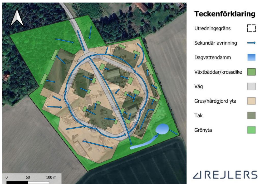
Figur 39 Sekundära avrinningsvägar inom planområdet. Bild: Rejlers
