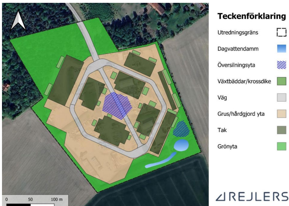
Figur 40 Förslag på översilningsytor vid skyfall. Bild: Rejlers
