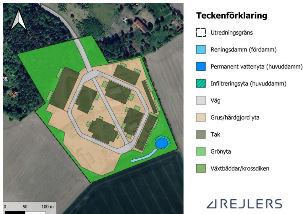
Figur 34 Föreslagen dagvattenlösning för planområdet. Bild: Rejlers.
