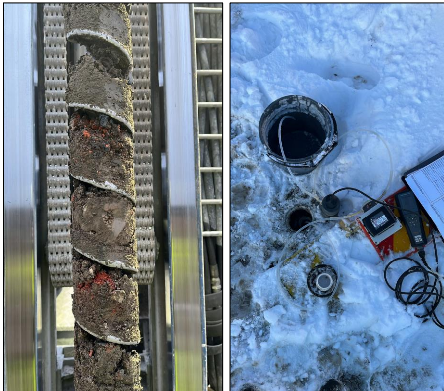
Figur 3. Skruv 24RE09 (0-1,6 m) som visar tegelbitar i fyllningsmaterialet (vänster). Vattenprovtagning av grundvattenrör 24RE11 (höger).
