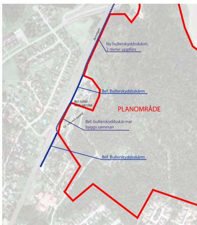
Illustration över kompletterande bullerskyddsskärmar i enlighet med trafikbullerutredning. Planområdets gräns är markerad med rött.
