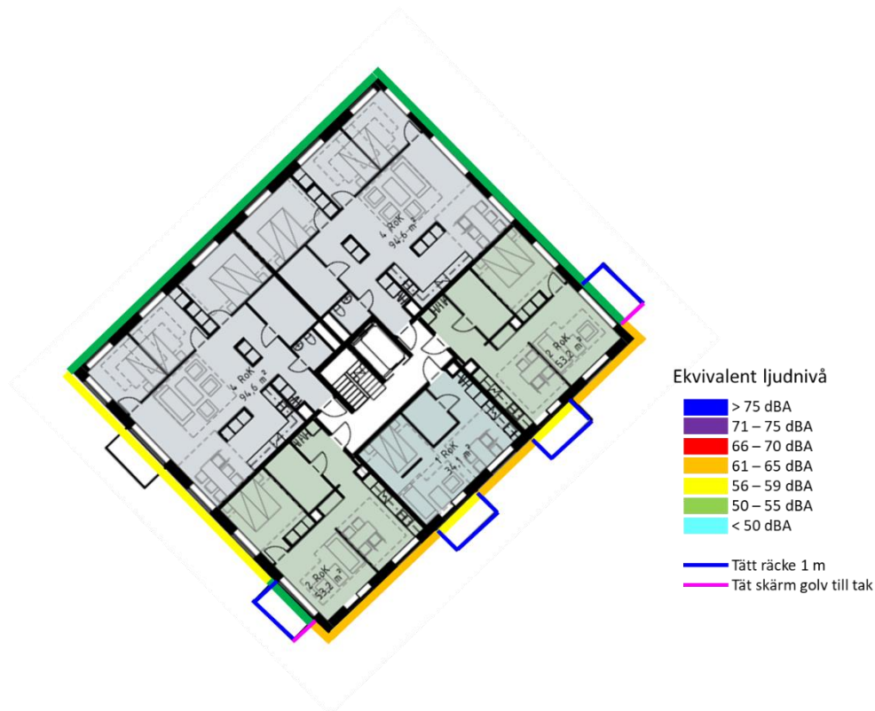
Figur 2. Ljudnivåer vid fasader med täta räcken och tät skärm, plan 10-13, hus 1. Ljudnivåer avser en höjd på 1,8 m ovan balkonggolv.
