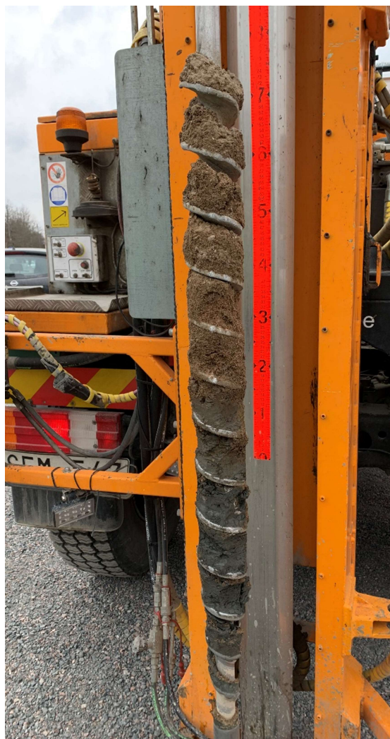
Figur 5a. Övergång mellan fyllning bestående av grusig sand (med inslag av tegel) och fyllning bestående av torrskorpelera, punkt 21B07 (0,1–1 m u my).
