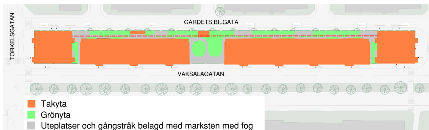
Figur 11. Planerad markanvändning inom JM:s del av utredningsområdet. Röd streckad linje avser gräns för underbyggt garage/källare; ytan närmast Gårdets bilgata är ej underbyggd av garage/källare.
