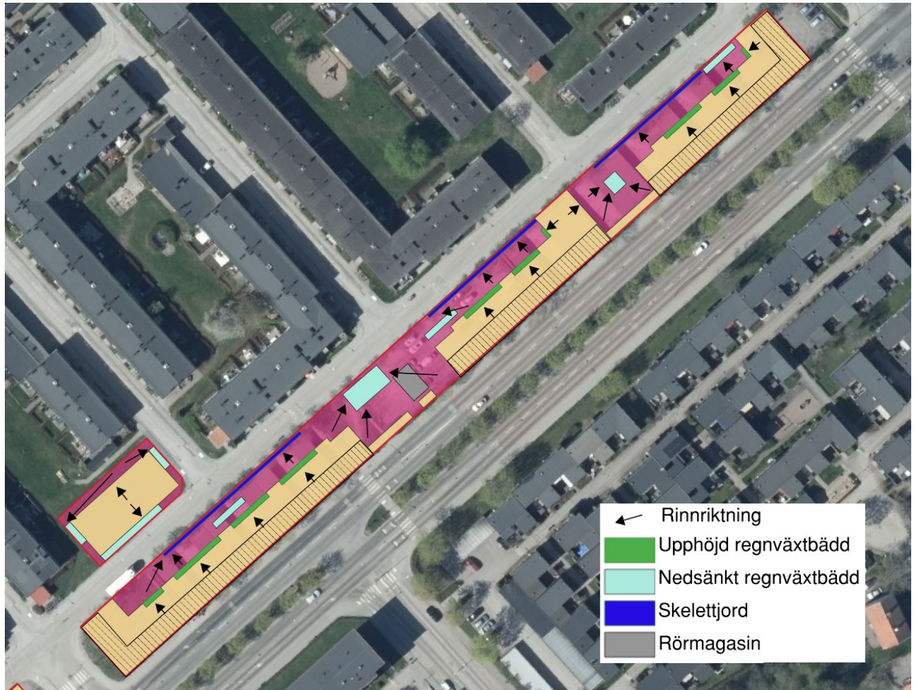
Figur 18. Åtgärdsförslag för dagvatten för Uppsalahems område. Tak som antas luta ut mot Vaksalagatan är skrafferade. 25 % av tak som lutar ut mot Vaksalagatan antas kunna avledas till ett underjordiskt rörmagasin.
