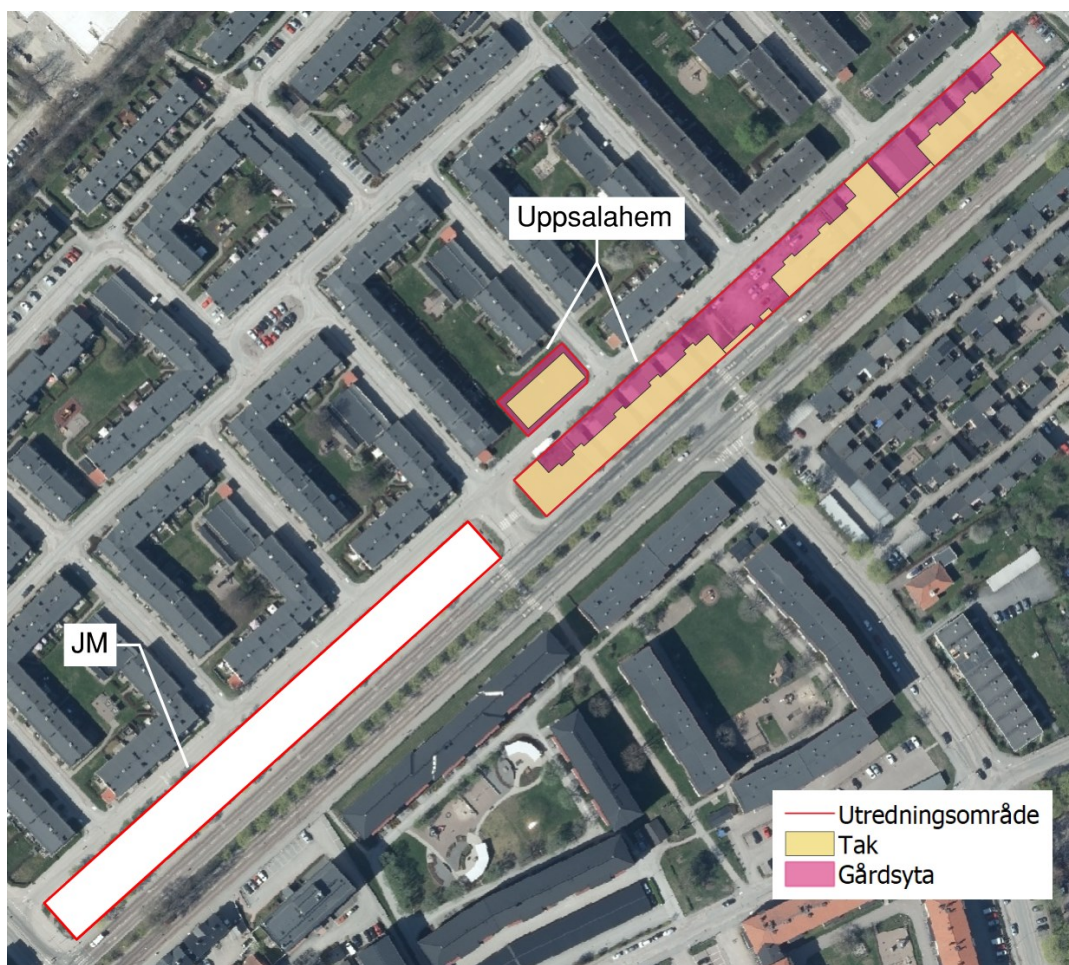
Figur 10. Planerad markanvändning för Uppsalahems del av utredningsområdet. För Uppsalahems del av utredningsområdet antas gårdsytorna utgöras av 1/3 grönytor, 1/3 grusytor och 1/3 asfaltsytor. Bakgrundskarta Ortofoto Lantmäteriet.
