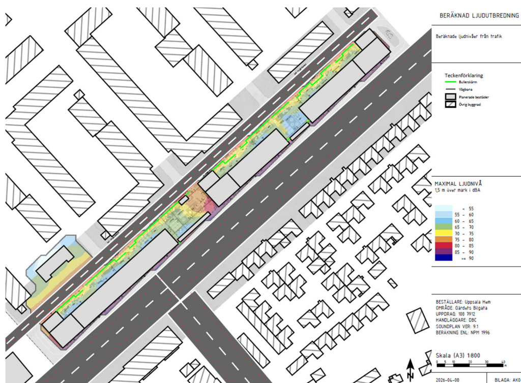
Figur 36. Ljudutbredningskarta för maximal nivå. Kartan visar höga nivåer mot Vaksalagatan och på gavlarna (orange 75–80 dBA, röd 80–85 dBA, lila 85–90 dBA), och en tystare sida mot Gärdets bilgata (blå 60–65, grön 65–70, gul 70–75 dBA). Huvuddelen av gården får tydligt under 70 dBA maximal ljudnivå. Bild: Norconsult.
