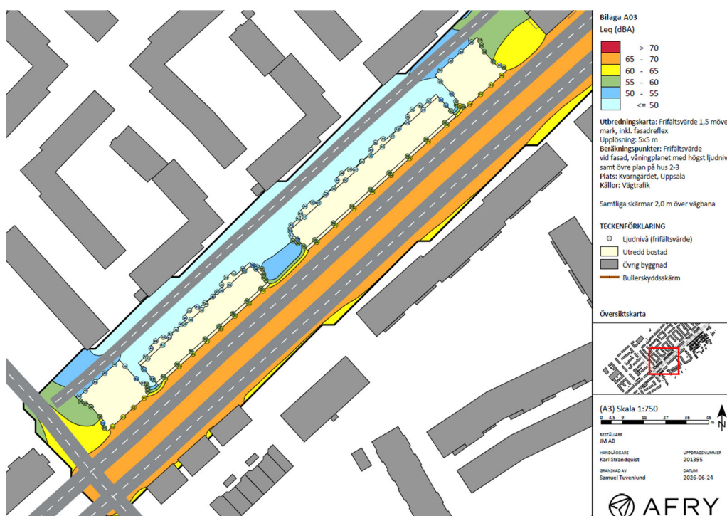
Figur 37. Ljudutbredningskarta för ekvivalent nivå. Kompletterar 3D-redovisningen ovan och visar att sidan mot Gärdets bilgata får ekvivalenta bullernivåer under 60 dBA, och stora delar får under 55 dBA. Bild: AFRY.
