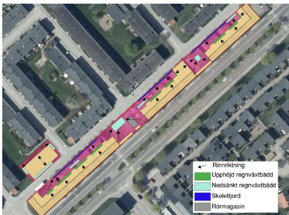
Figur 32 Översiktlig illustration av planerad dagvattenhantering inom planområdets nordöstra kvarter. Dagvatten från tak och hårdgjorda ytor fördröjs inom regnväxtbäddar, rörmagasin och skelettjordar. Bild: Bjerking. 2024-06-27 rev. 2026-01-05.
