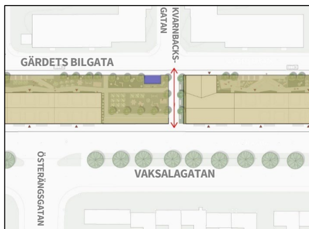
Figur 28 Illustration av planerad passage för gående och cykeltrafik mellan Gärdets bilgata och Vaksalagatan. De gula och blå ytorna representerar kvartersmark inom detaljplanen. Röd pil visar läget för passagen, som ges en bredd av 5,5 meter. I genomförandeskedet behöver det studeras hur ytan ska utformas och om viss plantering är möjlig.
