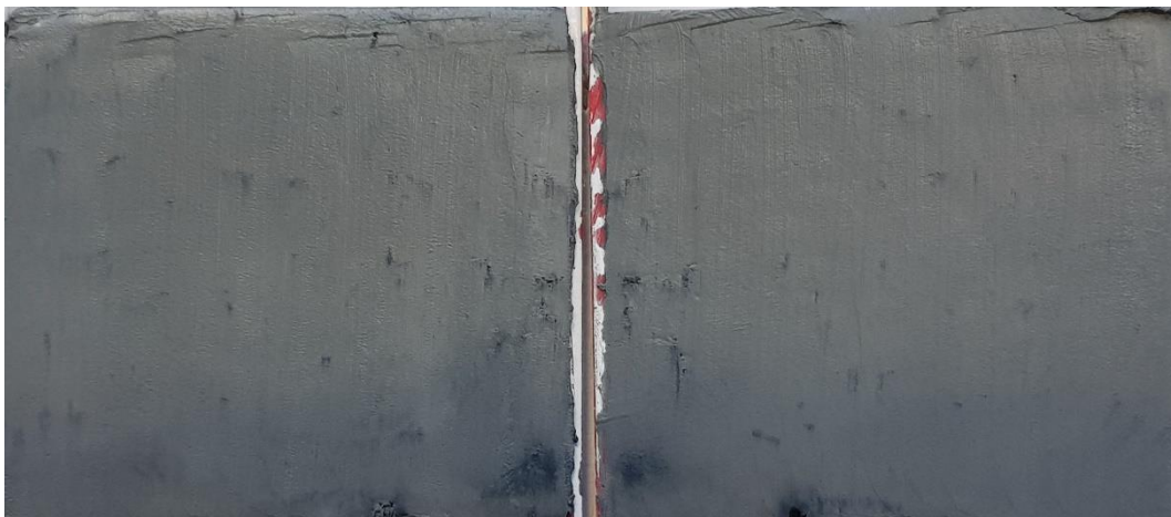
Figur 4 Borrpunkten, 21B13, 5,0 m, Jordprovet i nedre delen av mellanhylsan delad longitudinellt provhylsan med id Bjerking 854.
