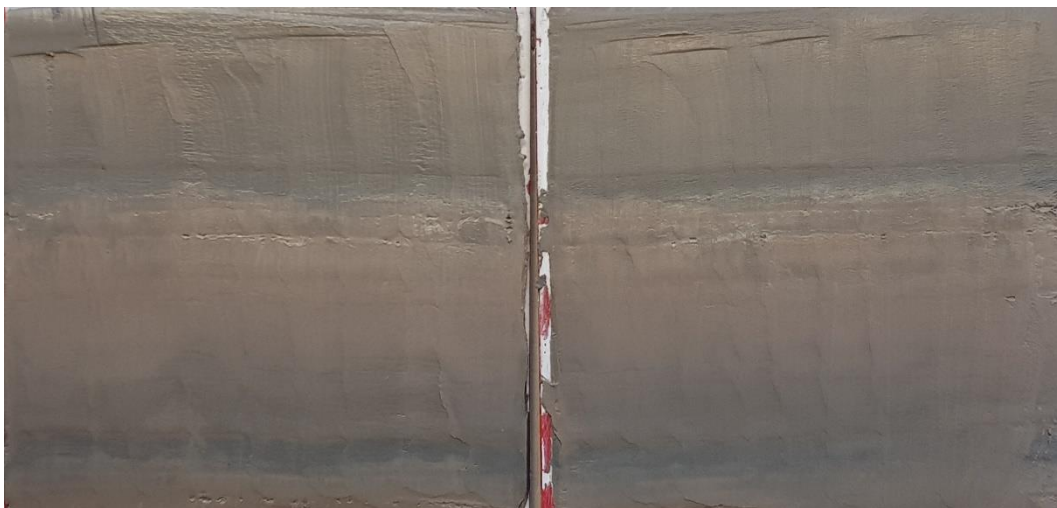
Figur 5 Borrpunkten, 21B13, 12,0 m, Jordprovet i nedre delen av mellanhylsan delad longitudinellt provhylsan med id Bjerking 998.
