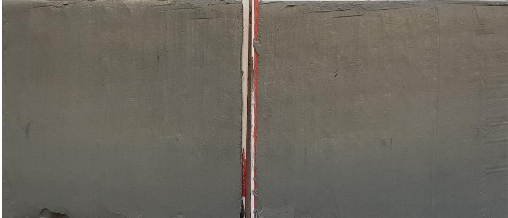
Figur 1 Borrpunkten, 21B02, 5,0 m, Jordprovet i nedre delen av mellanhylsan delad longitudinellt provhylsan med id Bjerking 1311.
