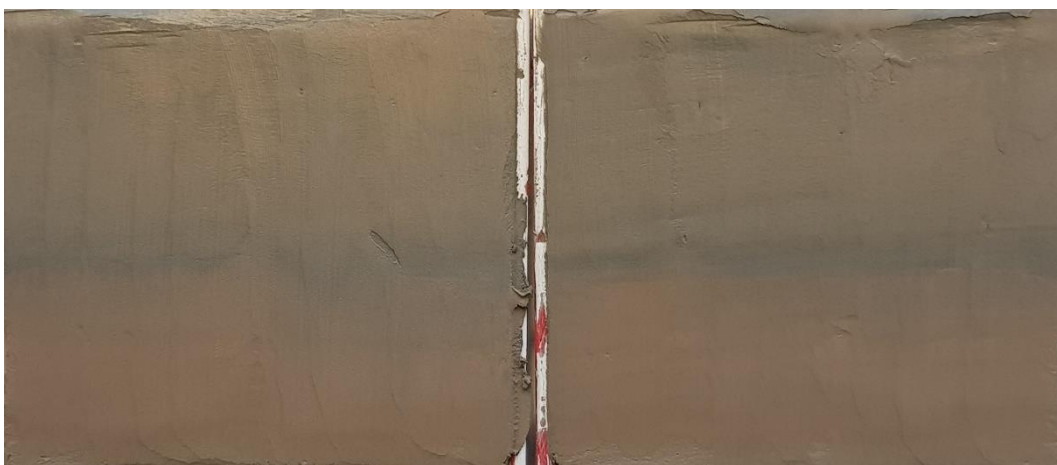
Figur 6 Borrpunkten, 21B13, 17,0 m, Jordprovet i nedre delen av mellanhylsan delad longitudinellt provhylsan med id Bjerking 1072.
