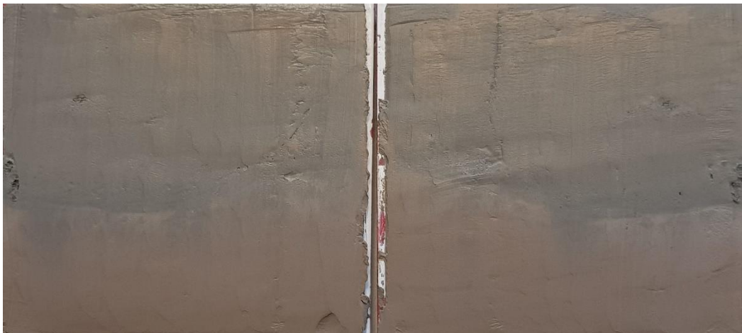
Figur 2 Borrpunkten, 21B02, 5,0 m, Jordprovet i nedre delen av mellanhylsan delad longitudinellt provhylsan med id Bjerking 1303.
