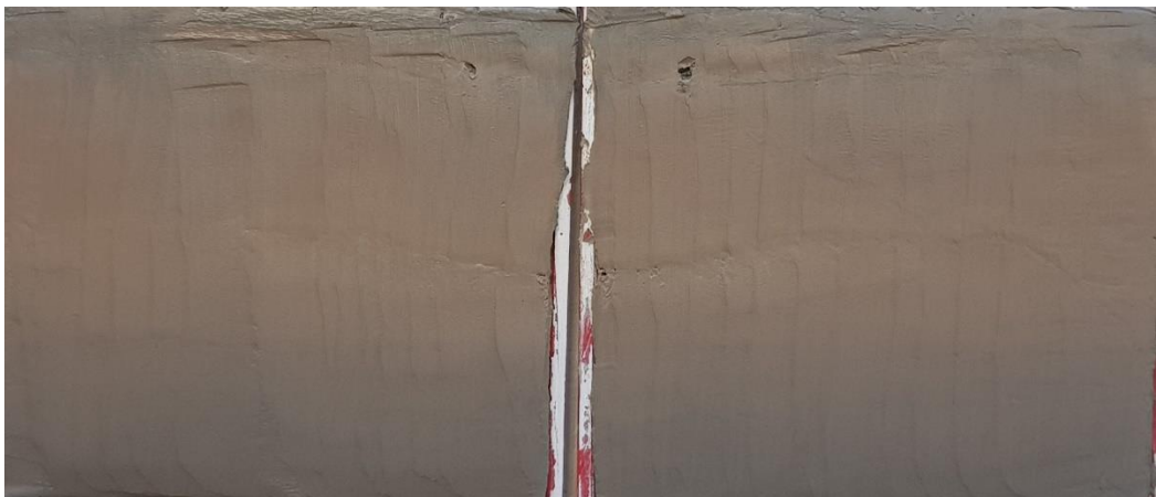
Figur 3 Borrpunkten, 21B02, 5,0 m, Jordprovet i nedre delen av mellanhylsan delad longitudinellt provhylsan med id Bjerking S 556.
