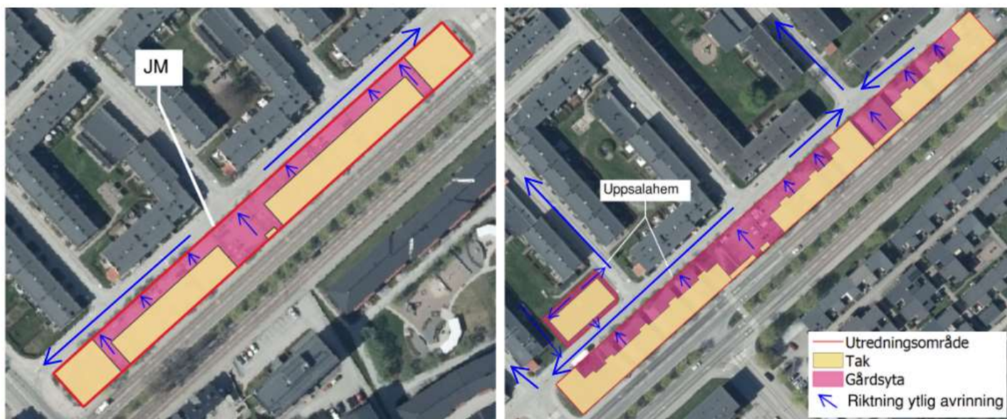
Figur 16. Utredningsområdet och planerad markanvändning. Blå pilar illustrerar skyfallsvattens rinnriktning.
