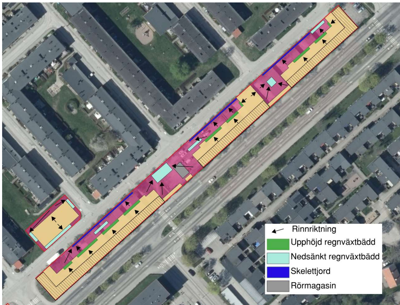
Figur 18. Åtgärdsförslag för dagvatten för Uppsalahems område. Tak som antas luta ut mot Vaksalagatan är skrafferade. 25 % av tak som lutar ut mot Vaksalagatan antas kunna avledas till ett underjordiskt rörmagasin.
