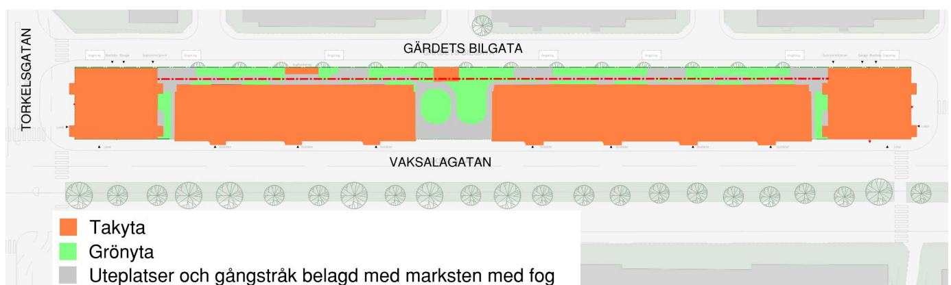
Figur 11. Planerad markanvändning inom JM:s del av utredningsområdet. Röd streckad linje avser gräns för underbyggt garage/källare; ytan närmast Gärdeets bilgata är ej underbyggd av garage/källare.
