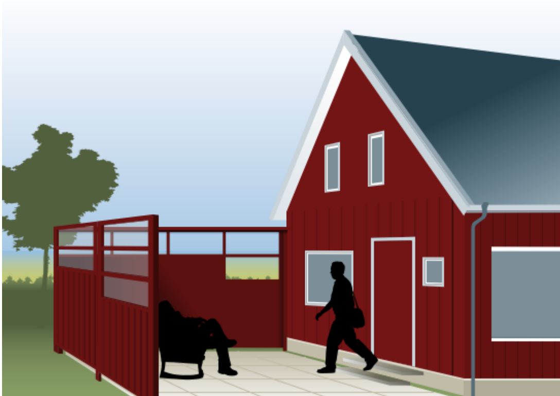
Figur 6. Principskiss av Trafikverkets rekommenderade bullerskyddsskärm för skydd av uteplatser
