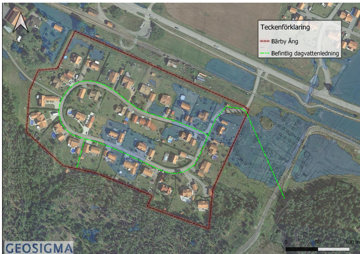
Figur 3-1. Bärby Äng med befintlig dagvattenledning och lågstråksområden.
