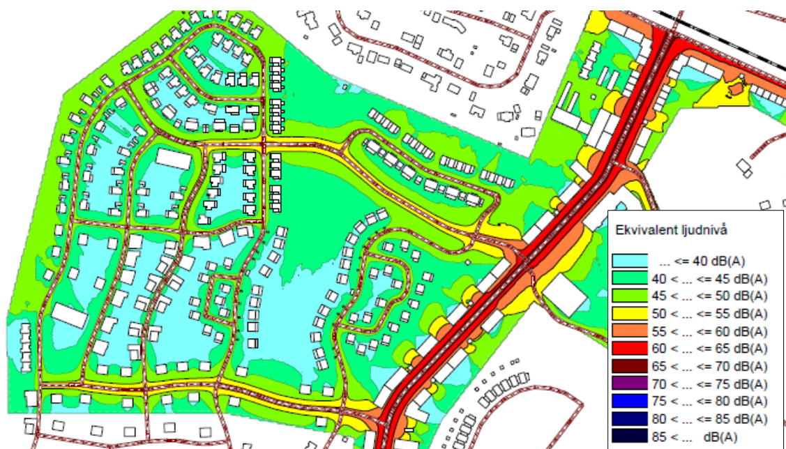
Utdrag ur Trafikbullerutredning Södra Gunsta, 2016, Bjerking. Bilden visar de ekvivalenta nivåerna för väg- och järnväg vid 2 meters höjd.
