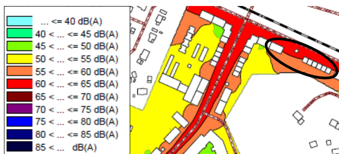
Utdrag ur Trafikbullerutredning Södra Gunsta, 2016, Bjerking. Bilden visar de ekvivalenta nivåerna för väg- och järnväg vid 13 meters höjd. Svart oval markerar område där ljudnivåerna på denna höjd överskrider 55 dBA ekvivalent även vid den mest ljuddämpade sidan.
