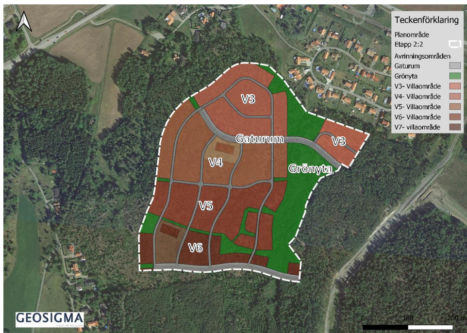
Figur 3-10. Förslag till framtida tekniska delavrinningsområden inom detaljplaneområdet för etapp 2:2 i Södra Gunsta, som i föreliggande rapport använts vid dagvattenberäkningarna.
