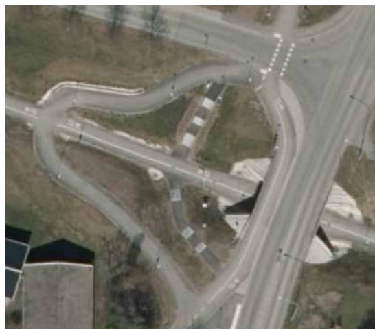
Korsningen Gamla Uppsalagatan-Orvars väg före (till vänster) och efter ombyggnad (till höger). Åtgärden bidrar till ökad säkerhet och framkomlighet för både gående och cyklister genom att bland annat gång- och cykelbanan lagts på tunneltaket, hållplatser tillgänglighetsanpassats samt att trappor för fotgängare och farthinder för motorfordonstrafik byggts.
