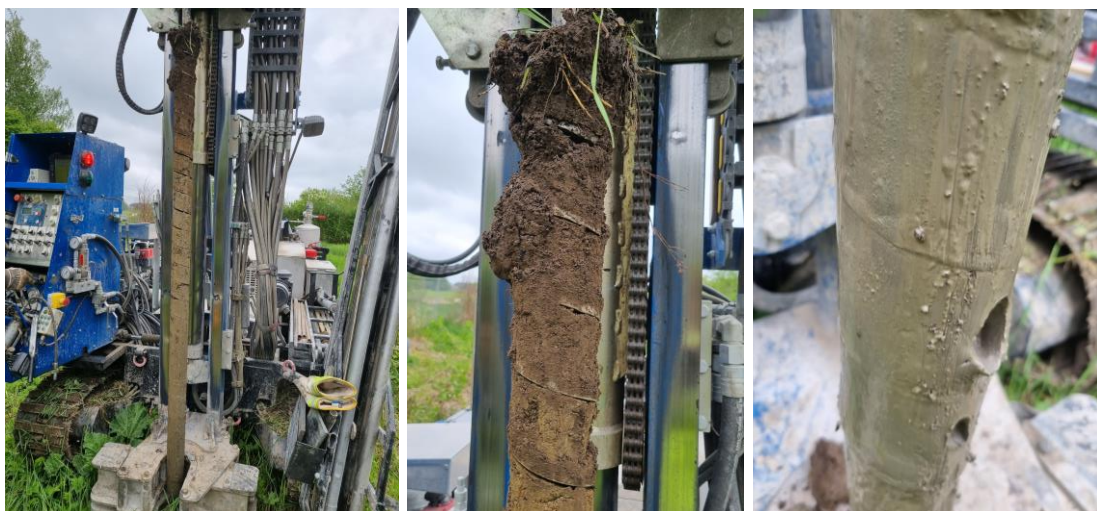
Bild 3.1.3 – 3.1.5: Bilderna visar skruvprov från punkt 1, djup 0 – 2 m. Överst förekommer organisk jord som övergår i en fast lera som blir mycket lös från ca 1,6 m.
