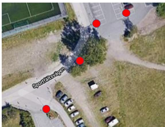
Det utfördes mätningar av belysningsstyrka i 8st punkter (se bild ovan till höger), horisontellt resp. vertikalt i varje punkt, cirka 1m över mark.
