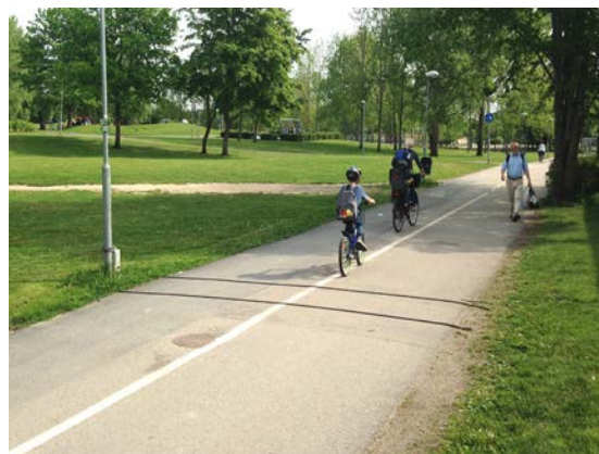
Cykelräkning i Gränbyparken genom så kallad slangmätning.
