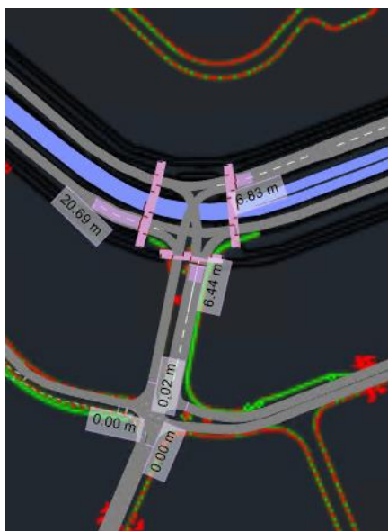
Figur 10. Medelkölängd under eftermiddagens simulerade maxtimme för korsningen vid Musikvägen
