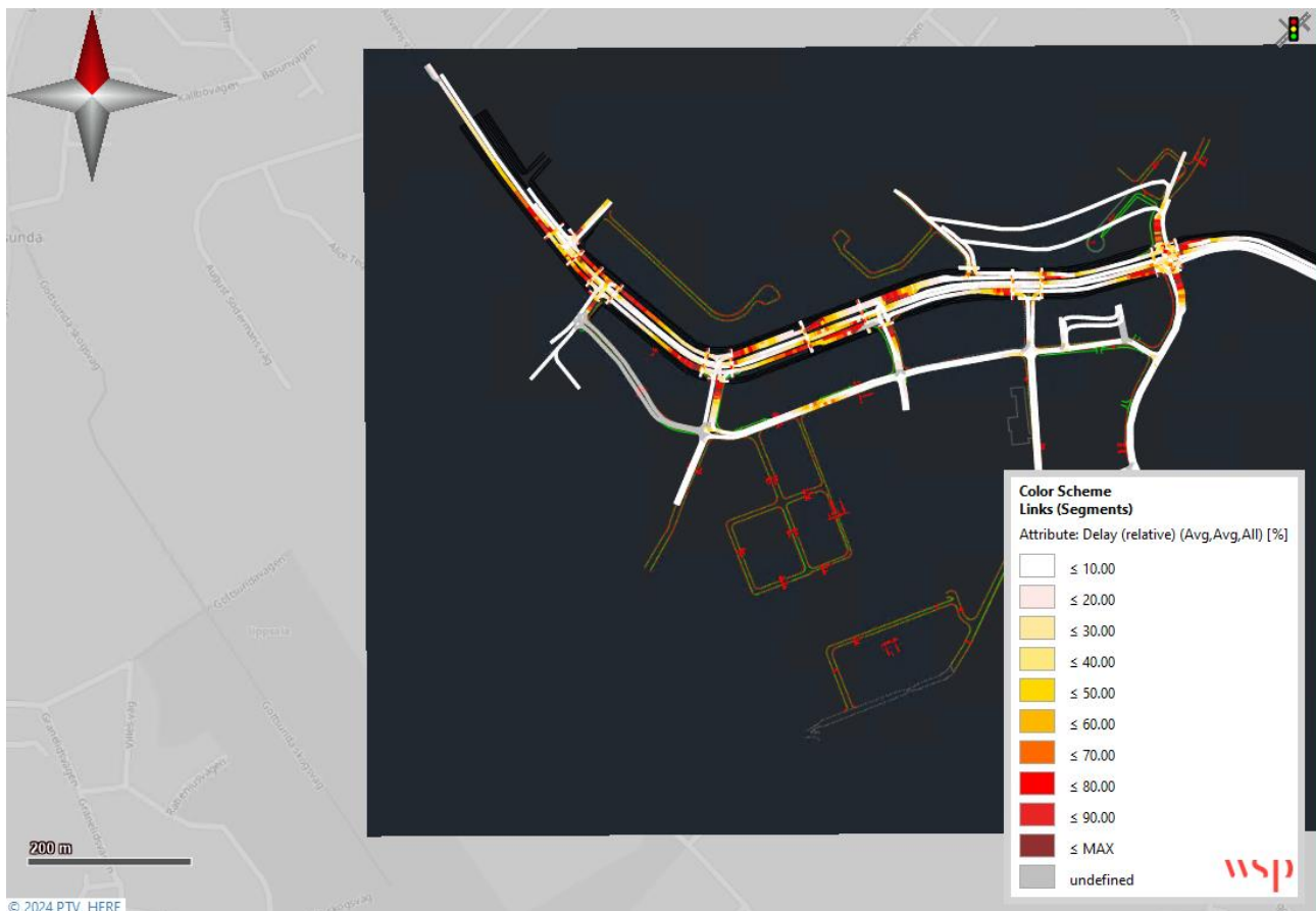
Figur 12. Relativ fördröjning under eftermiddagens simulerade maxtimme
