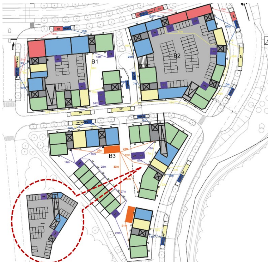
Figur 20. Illustration som redovisar en möjlig lösning av parkeringsplatser, med garage i bottenvåningarna i de norra kvarteren och garage under den nordöstra delen av det södra kvarteret. Ljusbul färg anger miljörum, blå färg redovisar plats för cykelrum. Grön färg symboliserar bostäder och röd färg lokaler. Illustration Mandaworks och Warm in the Winter, modifierad av Uppsala kommun
