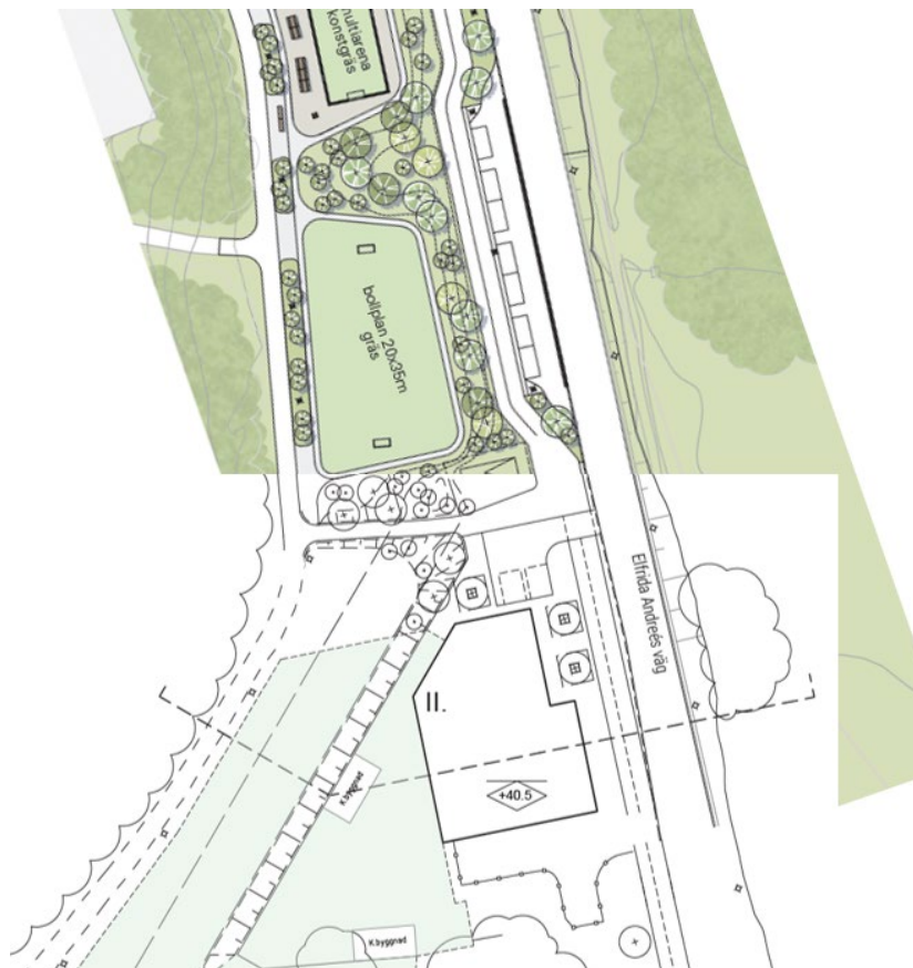
Figur 21. Möjlig utformning av angöringsfunktioner vid förskolan. Norr om byggnaden finns möjlighet att anordna parkeringsplatser för personer med nedsatt rörelse- eller orienteringsförmåga inom fastigheten och söder om byggnaden en yta för leveranser och sophantering. Hämta/lämna för förskolan kan anordnas i höjd med allaktivitetsytan och samnyttjas. Illustration Karavan, Mandaworks och Warm in the Winter, modifierad av Uppsala kommun
