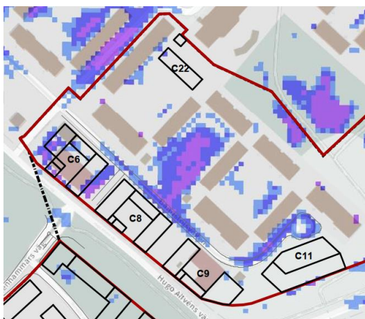
Figur 49. Till vänster: Skyfallskartering för området kring Bandstolsvägen. Skyfallskarteringen baseras på befintliga markhöjder medan nya byggnader visas enbart som information. Till höger: Ny strukturplan. Regnbäddar är planeras i lokalgatan för omhändertagande av dagvatten vid normala regn men de yttliga magasinen i anläggningarna kan även avlasta vid kraftiga regn. I släppet mellan kvarter C6 och C8 bör dagvattenhantering med fördröjande förmåga (blå markering) implementeras, eftersom en huskropp är placerad på befintlig lågpunkt.
