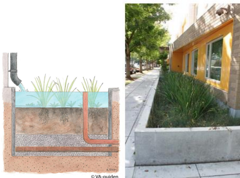
Figur 28. Till vänster: Principskiss över en regnbädd (VA-guiden). Till höger: Exempel på en regnbädd på kvartersmark (Stockholm Vatten och Avfall)
