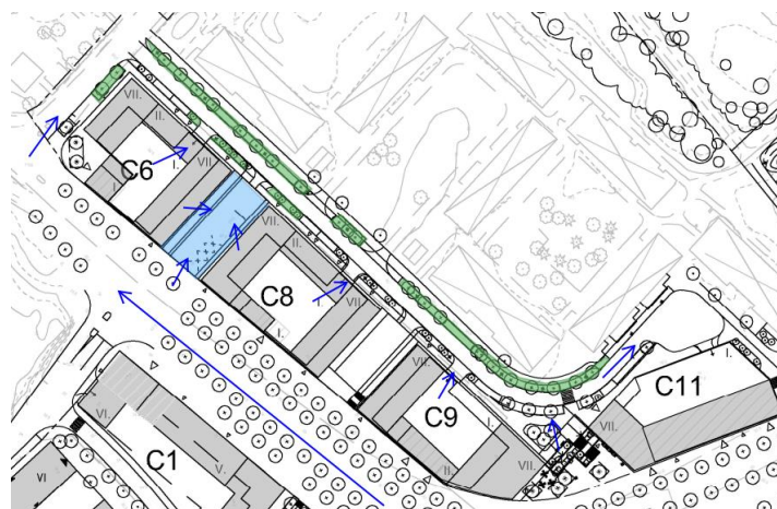
Figur 49. Till vänster: Skyfallskartering för området kring Bandstolsvägen. Skyfallskarteringen baseras på befintliga markhöjder medan nya byggnader visas enbart som information. Till höger: Ny strukturplan. Regnbäddar är planeras i lokalgatan för omhändertagande av dagvatten vid normala regn men de yttliga magasinen i anläggningarna kan även avlasta vid kraftiga regn. I släppet mellan kvarter C6 och C8 bör dagvattenhantering med fördröjande förmåga (blå markering) implementeras, eftersom en huskropp är placerad på befintlig lågpunkt.
