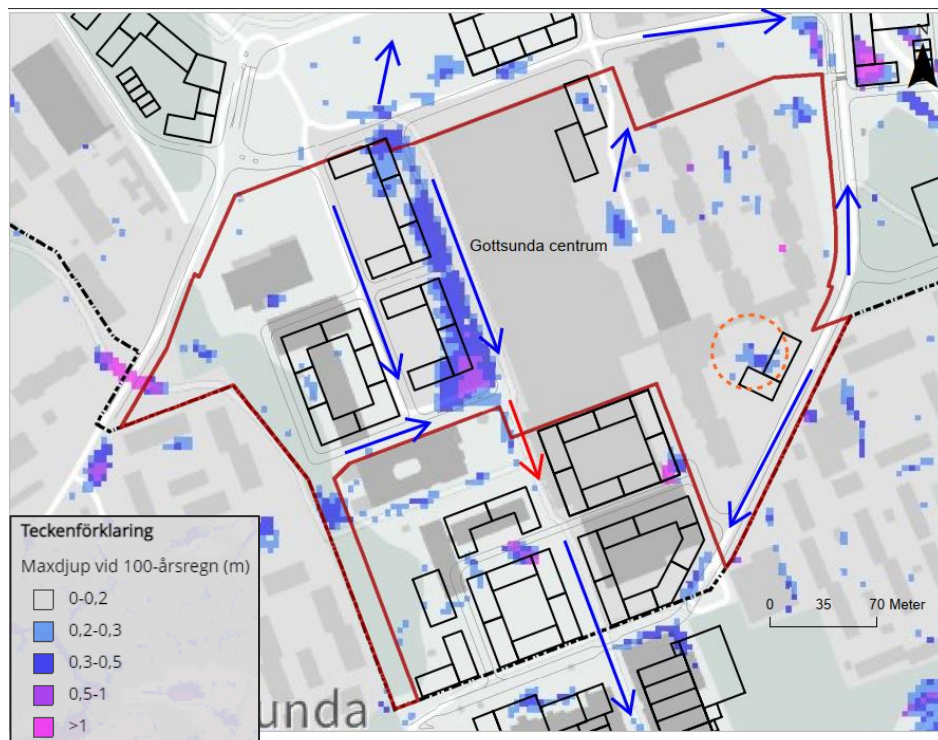
Figur 40. Skyfallskartering inom detaljplan A. Skyfallskarteringen baseras på befintliga markhöjder medan nya byggnader visas enbart som information. Detaljplanegräns är markerad med röd linje. Blå pilar visar sekundära flödesvägar. Röd pil visar rännvåg där en tröskelnivå behöver uppnås för att vattnet ska kunna rinna vidare söderut. Inringat område i orange är en lokal lågpunkt där en ny byggnad är placerad (kvarter A7) och åtgärder krävs. (Uppsala kommun, 2020)
