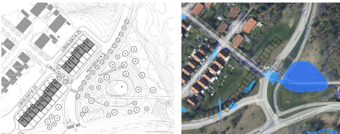
Figur 48. Till vänster: Ny strukturplan och översvämningssyta öster om Slädvägen. Översvämningssytan är multifunktionell då den i normala fall kan fungera som parkyta för rekreation och lek och kan översvämmas vid extrema regn. Till höger: Ny höjdsättning med översvämningssyta är modellerad i beräkningsverktyget Scalgo Live. Denna leder till förbättrad situation för befintlig bebyggelse samt möjliggör ny struktur. Höjdsättning och markmodellering av översvämningssytan pågår i förprojekteringen, men analysen i Scalgo Live visar principen av sänkt tröskel och effekten för befintlig och ny bebyggelse.
