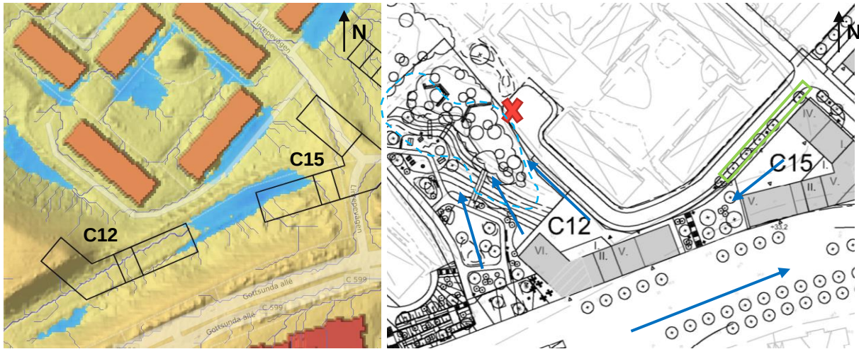
Figur 46. Till vänster: Befintlig topografi och struktur. Framtaget i Scalgo Live, vald regnmängd är 38 mm. Visar flödesvägar och lågpunkter. Till höger: Föreslagen struktur och utformning av Centruparken. Regnbäddar (grön markering) planeras på ny lokalgata norr om C15 för att omhänderta dagvatten och skydda befintlig bebyggelse. Lokalgatan lutas mot det nedsänka grönområdet (blå streckad linje) i Centruparken. Tröskeln (rött kryss) ska behållas för att inte försämrade för nedströms liggande område.
