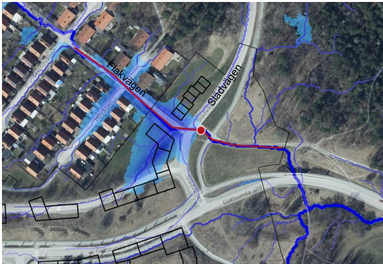
Figur 42. Lågpunktsanalys i Scalgo Live. Instängt område vid korsningen Flakvägen/Slädvägen. En tröskel (se röd markering) öster om Slädvägen hindrar vattnet från att rinna vidare mot grönytan och Ravinen. Till höger visas profilen för lågpunkten där höjder visas längs med den röda linjen i bilden till vänster.
