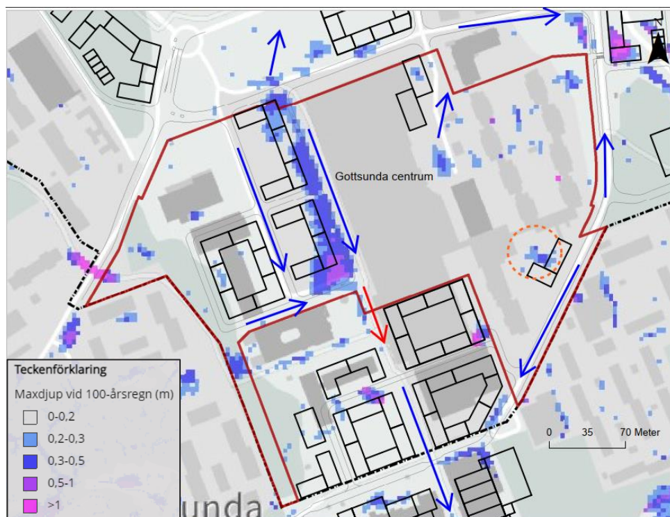
Figur 34. Skyfallskartering inom detaljplan A. Detaljplanegräns är markerad med röd linje och utredningsområdet med svart streckad linje. Blå pilar visar sekundära flödesvägar. Röd pil visar rinnväg där en viss tröskelnivå behöver uppnås för att vattnet ska kunna rinna vidare söderut. Inringat område i orange är en lokal lågpunkt där en ny byggnad är placerad (kvarter A7) och åtgärder krävs. (Uppsala Vatten, 2020)
